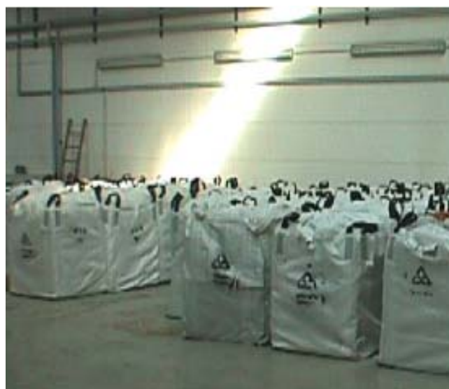
Figura 5 – “big bags” contendo resíduos radioactivos imobilizados em ligantes GP [38]
