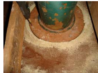
Figura 27 – Solo natural – ruptura por puncionamento
