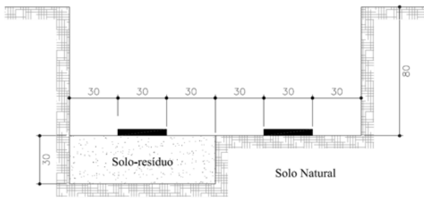
Figura 11 – Posicionamento das placas e dimensões – corte longitudinal (dimensões em cm)
