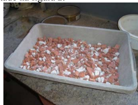
Figura 2 – Resíduo com 50% de material cerâmico e 50% de material argamassado
