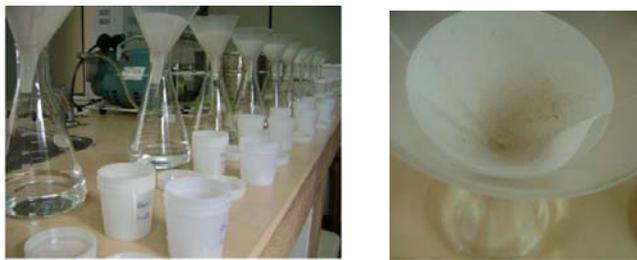
**Figura 4:** À esquerda, conjunto béquer-funil-papel filtro. À direita, detalhe do papel filtro dobrado.
