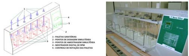
**Figura 3:** À esquerda, ilustração dos componentes do Jarteste. À direita, fotografia do equipamento.
