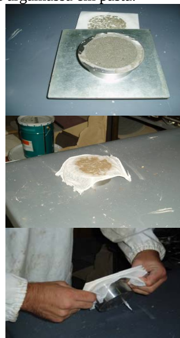
Figura 3 - Fases de execução do ensaio de retenção de água
