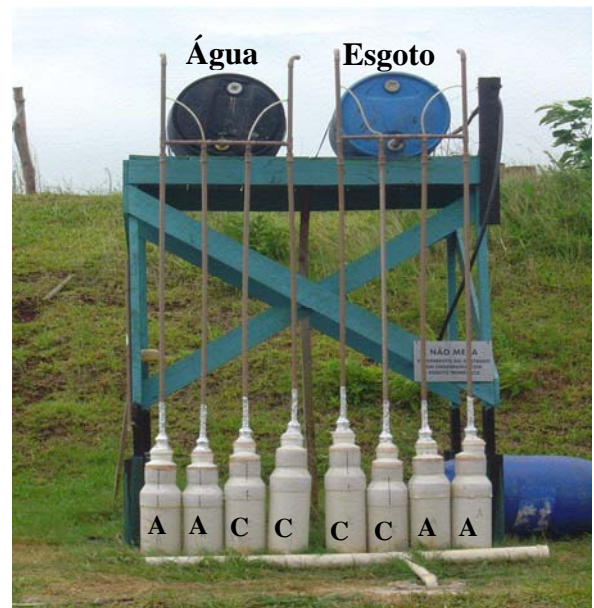
Figura 2 - Permeâmetro para estudo da colmatção
