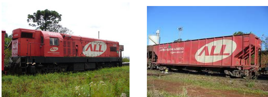
Figura 3 - Locomotiva modelo G12 e vagão tipo hopper
