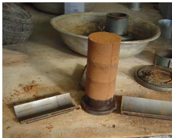
Figura 2: Corpo-de-prova após a moldagem e desmolde no cilindro tripartido (Rabassa et al [21])
