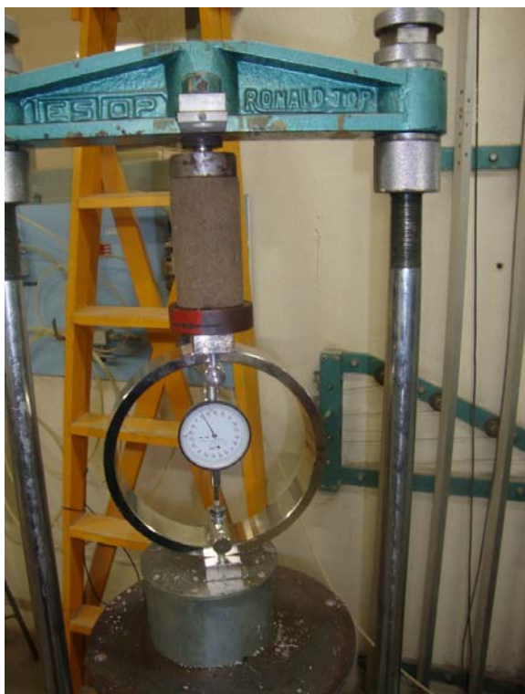
Figura 3: Aparato (prensa mais anel dinâmico) durante o rompimento dos corpos-de-prova
