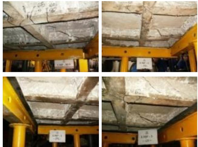
Figura 12: Fissuração característica após a ruptura
