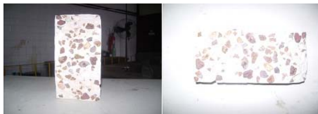
Figura 6 – Aspecto dos corpos-de-prova após o ensaio de compressão diametral
