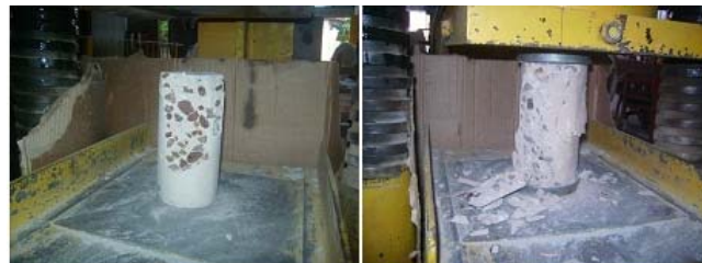
Figura 5 – Aspecto dos corpos-de-prova após o ensaio de compressão axial
