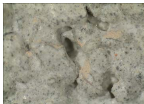
Figura 12 - Argamassa de referência, observada na lupa binocular electrónica, com uma ampliação de 30 vezes
