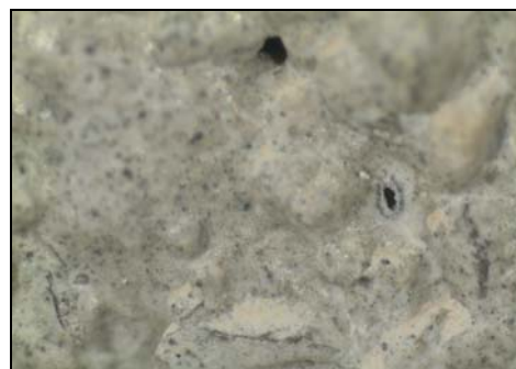
Figura 13 - Argamassa com 20% de incorporação de finos de vidro, observada na lupa binocular electrónica, com uma ampliação de 30 vezes
