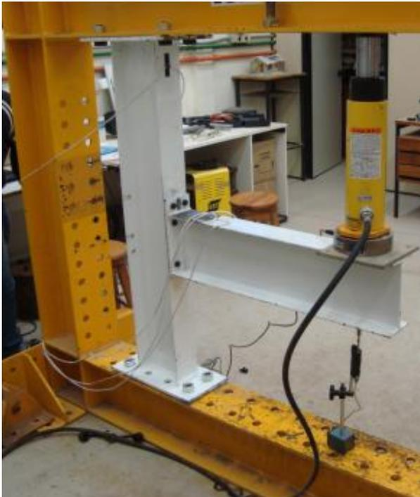
Figura 12 – Montagem do macaco e transdutor
