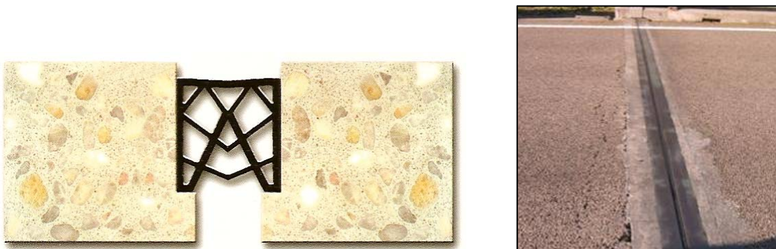
Figura 6 - Juntas em perfil de elastómero comprimido: esquema (à esquerda) (adaptado de [9]) e exemplo real (à direita) [5]
