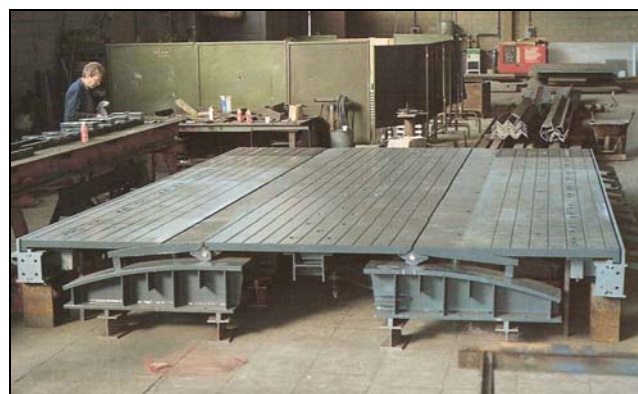
Figura 12 - Junta de placas deslizantes com roletes [11]
