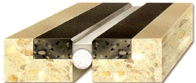
Figura 5 - Esquema de junta à superfície selada com material elástico (adaptado de [9])
