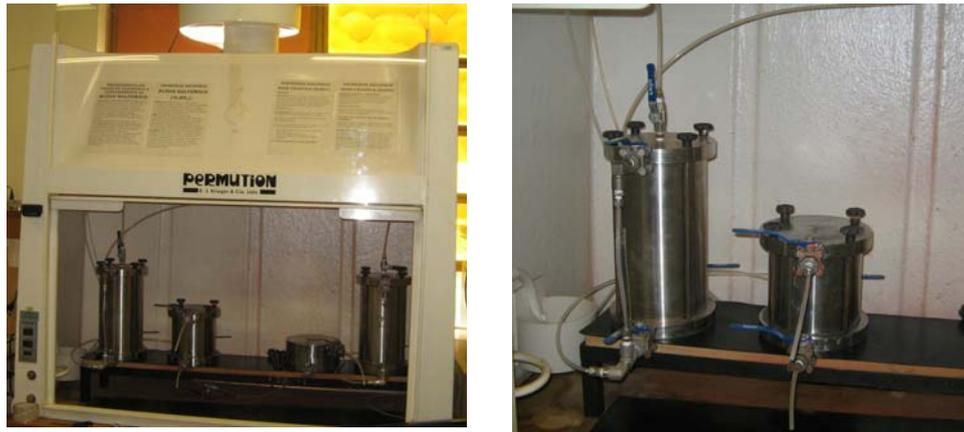
Figura 2 - Vista geral do permeâmetro de parede rígida
