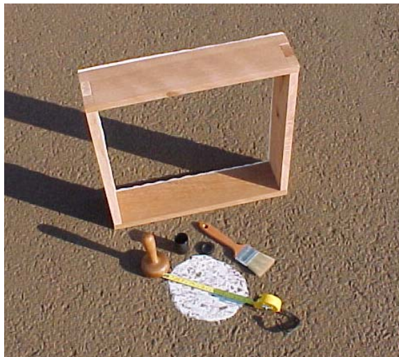
Figura 7 – Aparato utilizado para realização do ensaio de mancha de areia
