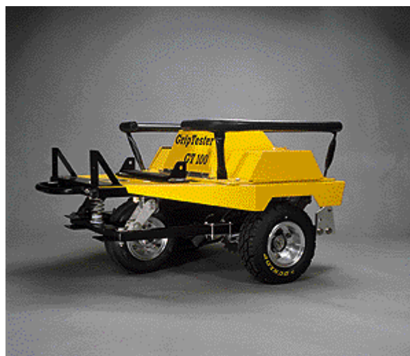
Figura 5 – Equipamento Griptester para medição do atrito Fonte: Mastrad (2007) [11]
