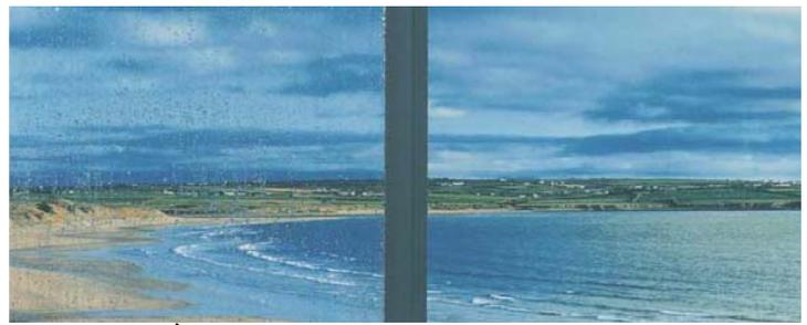
Figura 7 - À esquerda, um vidro normal; à direita, um vidro com uma camada de  $\text{TiO}_2$ , conferindo hidroflicidade [10]
