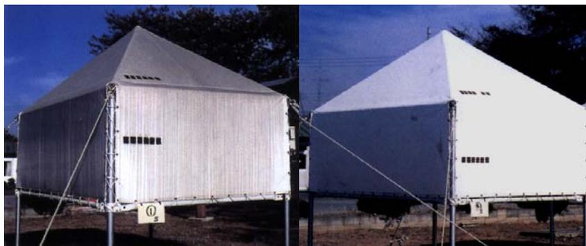
Figura 4 - Duas tendas semi-rígidas: à esquerda, não foi efectuado qualquer tratamento enquanto que à direita se encontra aplicada uma película de  $\text{TiO}_2$  [3]
