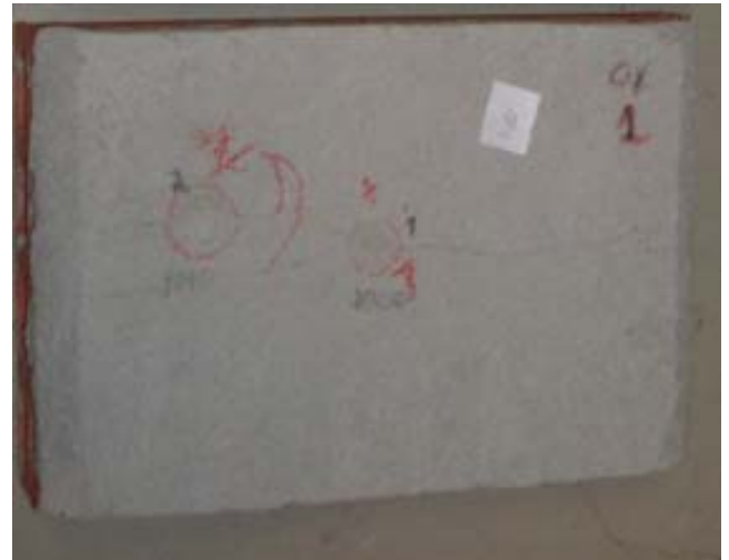
Figura 15 - Fissuras ocorridas na argamassa de referência no ensaio de resistência ao choque através da queda de uma massa conhecida
