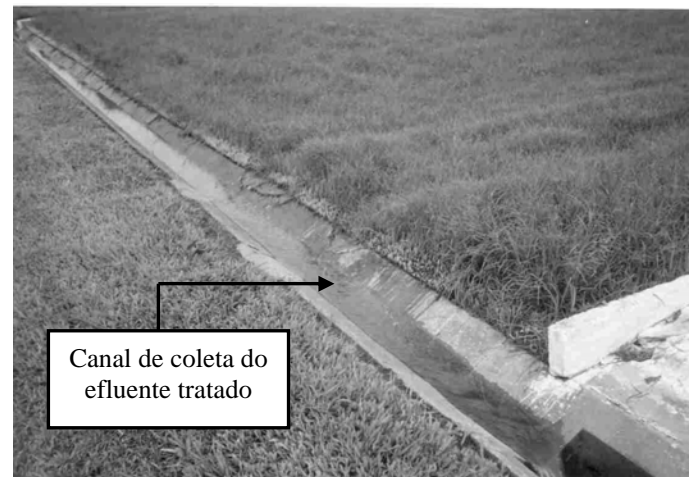
Figura 4 - Canal de coleta empregado em pesquisa na UNICAMP, posicionado na base da rampa de escoamento superficial no solo.
