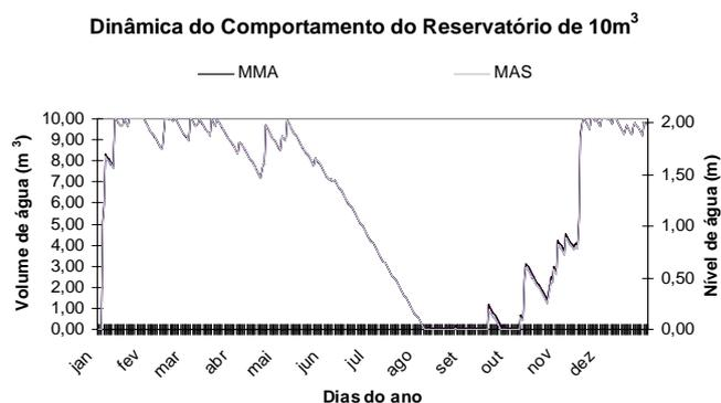
**Figura 8** Volume e nível de água no reservatório de  $10\text{m}^3$ , calculado para o potencial de economia em torno de 85%, durante o ano de 2003 considerando um área de captação de  $80\text{m}^2$ , descarte de primeira chuva de 2mm e demanda de  $0,12\text{m}^3/\text{dia}$ , utilizando o MMA e o MAS.
