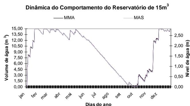
**Figura 9** Volume e nível de água no reservatório de  $15\text{m}^3$ , calculado para o potencial de economia em torno de 95%, durante o ano de 2003 considerando um área de captação de  $80\text{m}^2$ , descarte de primeira chuva de 2mm e demanda de  $0,12\text{m}^3/\text{dia}$ , utilizando o MMA e o MAS.
