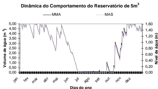
**Figura 7** Volume e nível de água no reservatório de  $5\text{m}^3$ , calculado para o potencial de economia em torno de 75%, durante o ano de 2003 considerando um área de captação de  $80\text{m}^2$ , descarte de primeira chuva de 2mm e demanda de  $0,12\text{m}^3/\text{dia}$ , utilizando o MMA e o MAS.
