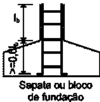
**Exceção:** Ancoragem das barras de espera dos pilares nas sapatas ou nos blocos de fundação
