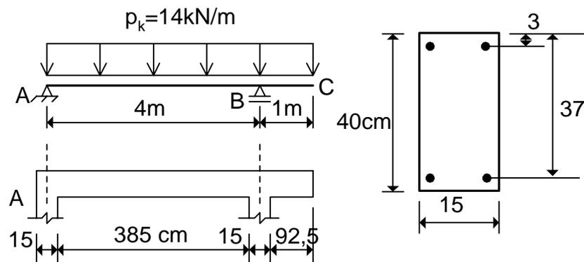
$f_{ck} = 20$  MPa; Aço CA-50; Usar barras longitudinais de  $\phi = 12,5$  mm (área de 1 barra =  $1,23\text{cm}^2$ ).
